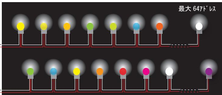
注) JCNET 製 DMX-PLC 対応 LED ランプをご使用下さい
